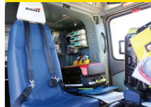
Eine neuartige, selbsttragende Innenraumverkleidung erlaubt eine flexible Anordnung medizinischer Geräte für eine optimale Patientenversorgung.
